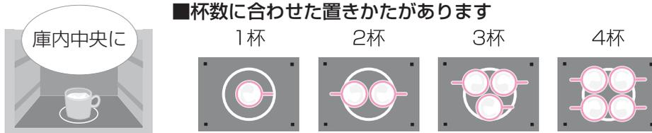
庫内の端に置くと赤外線センサーが正しく検知できず、沸とうするおそれがあります。必ず庫内四つ角のイラスト(■)より内側に置いてください。
